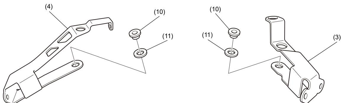
6. Montieren Sie die Teile wie in der Abbildung dargestellt, ohne sie festzuziehen.
