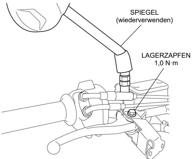
12. Montieren Sie die Teile, wie in der Abbildung dargestellt.
