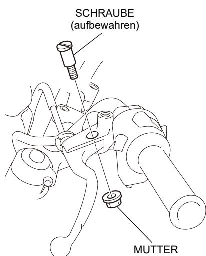
3. Montieren Sie die Teile wie in der Abbildung dargestellt, ohne sie festzuziehen.
