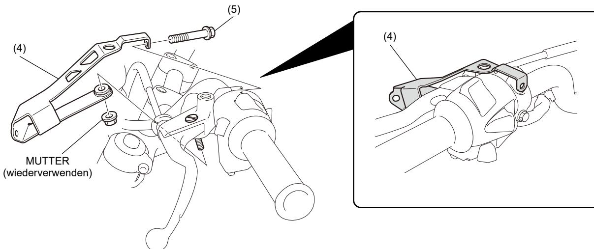
7. Montieren Sie die Teile wie in der Abbildung dargestellt, ohne sie festzuziehen. (図)
