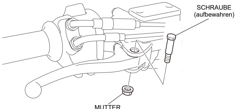
10. Montieren Sie die Teile wie in der Abbildung dargestellt, ohne sie festzuziehen.
