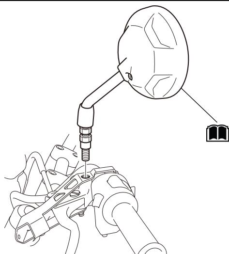
8. Ziehen Sie die lose montierten Teile fest an.
