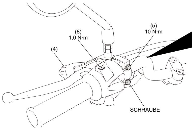
Richten Sie die Kontaktfläche der Hebelhalterung an der Körnermarkierung aus.
